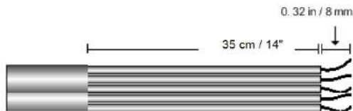
Ilustracja 39: Usuwanie izolacji – AC
