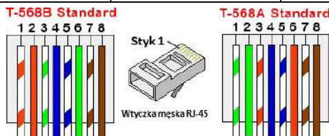
Ilustracja 22: Standardowe podłączenie kablowe
