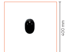
I-3: Håll avståndet runt hållare för fordonsladdningskontakt
