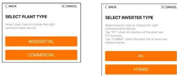
Rys. 6-3 Wybieranie typu elektrowni i falownika
