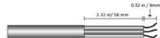
Ilustracja 12: Usuwanie izolacji – AC (kabel 3-żyłowy)
