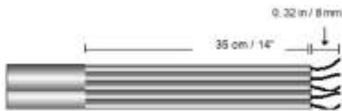
Ilustracja 39: Usuwanie izolacji – AC
