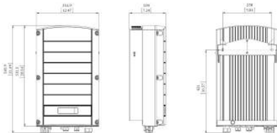
Ilustracja 31: Falownik jednofazowy z uchwytem typu 2 – widok z przodu, boku i z tyłu
