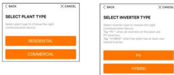
Rys. 6-3 Wybieranie typu elektrowni i falownika
