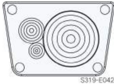
Rys. 5-3 Płytkę uszczelniającą dla jednego przewodu na fazę przy zastosowaniu kabla wielożyłowego.
